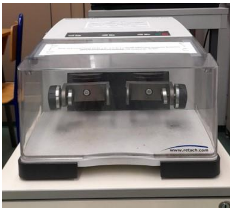
Slika 21. Vibracijski mlin Retsch MM200 korišten za mehanokemijsku sintezu.
