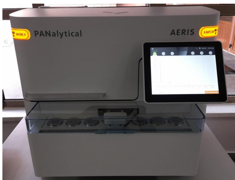
Slika 23. Difraktometar Malvern Panalytical AERIS korišten za rendgensku strukturnu analizu na polikristalnom uzorku.
