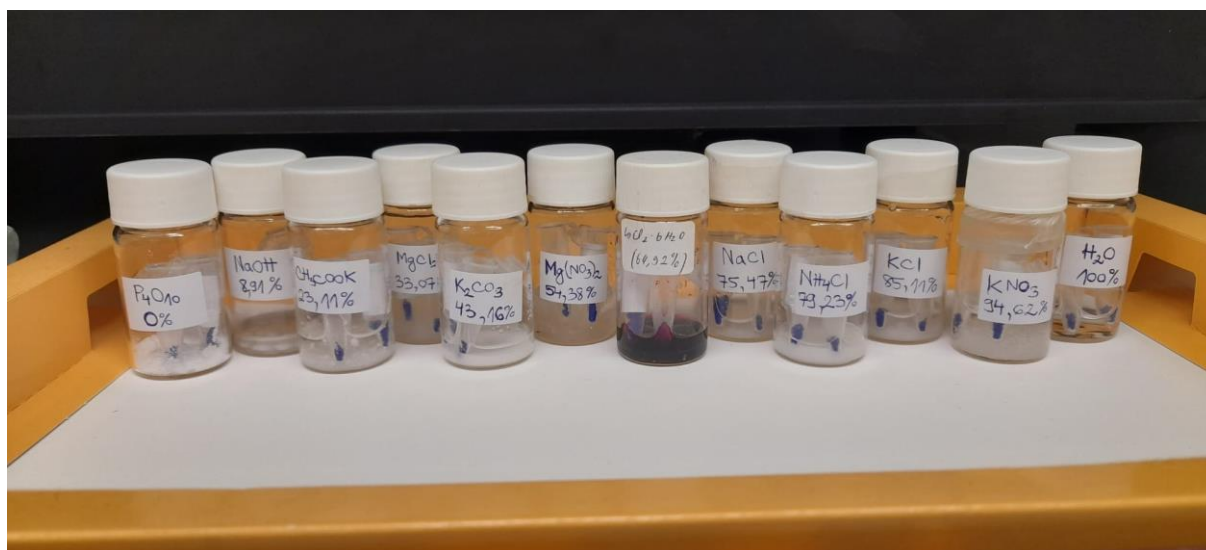
Slika 24. Komorice s atmosferama različitih relativnih vlažnosti postignutih korištenjem vode, fosforova(V) oksida i zasićenih otopina različitih soli.
