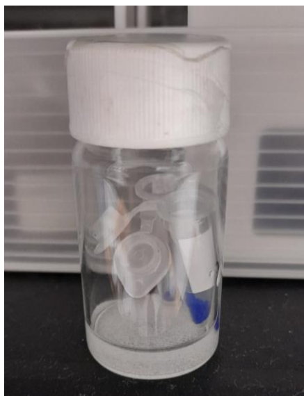
Slika 25. Uzorci spojeva 1a i 4a u Eppendorf epruveti smješteni u bočicu s otopinom zasićene soli.
