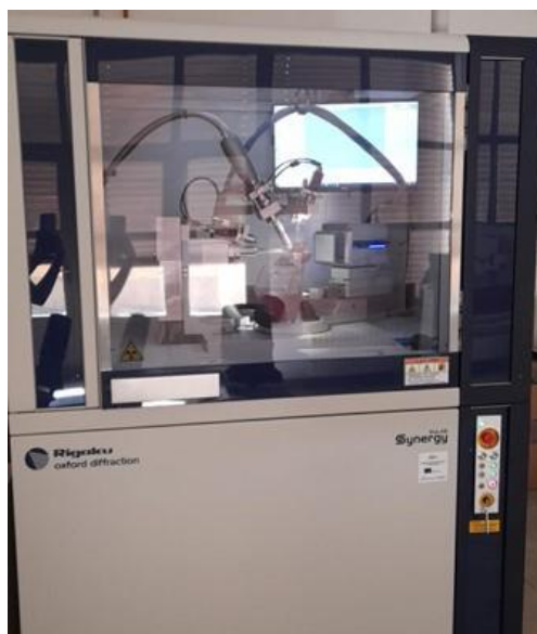
Slika 22. Difraktometar Rigaku XtaLAB Synergy-S korišten za rendgensku strukturnu analizu na jediničnom kristalu.
