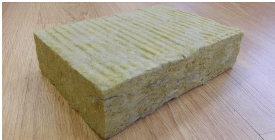
Slika 19 Izolacijski materijal nastao nakon obrade bazaltnih vlakana [30]
