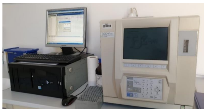
Slika 3.10. Uređaj za mjerenje TOC
