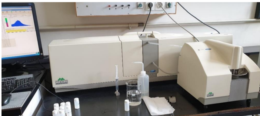
Slika 3.7. Mastersizer 2000, uređaj za mjerenje raspodjele veličina čestica
