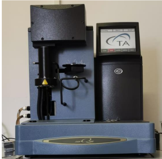
Slika 3.6. Uređaj za termogravimetrijsku analizu, TGA Q500
