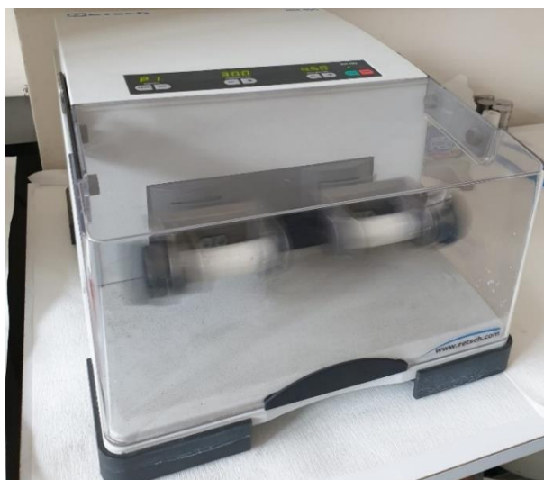
Slika 3.1. Uređaj za mehanokemijsku sintezu ZIF-8
