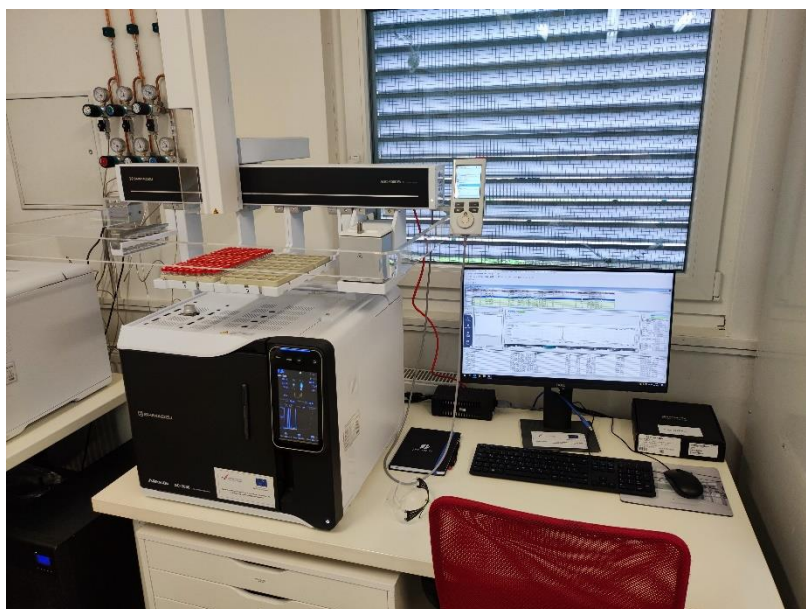
Slika 12. GC NEXIS GC-2030 s FID detektorom i dualnim autosampler -om AOC 6000 Plus
