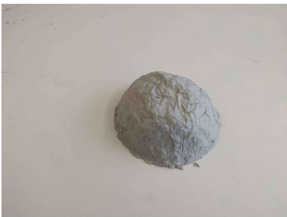
3 Vanjska strana uzorka dobivenog korišenjem cjedila kao kalupa
