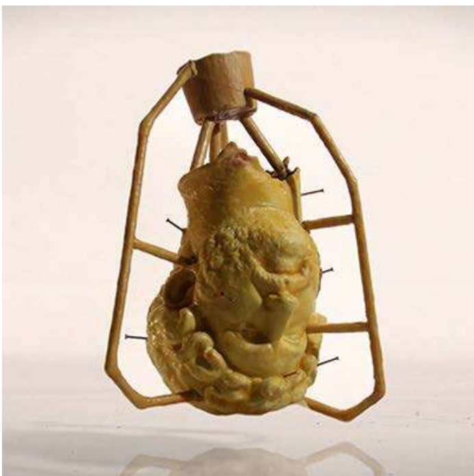
Kiparstvo: proces izgubljenog voska vosak kao pomoćni materijal https://www.core77.com/posts/50375/Video-Demonstrating-the-Lost-Wax-Casting-Process
