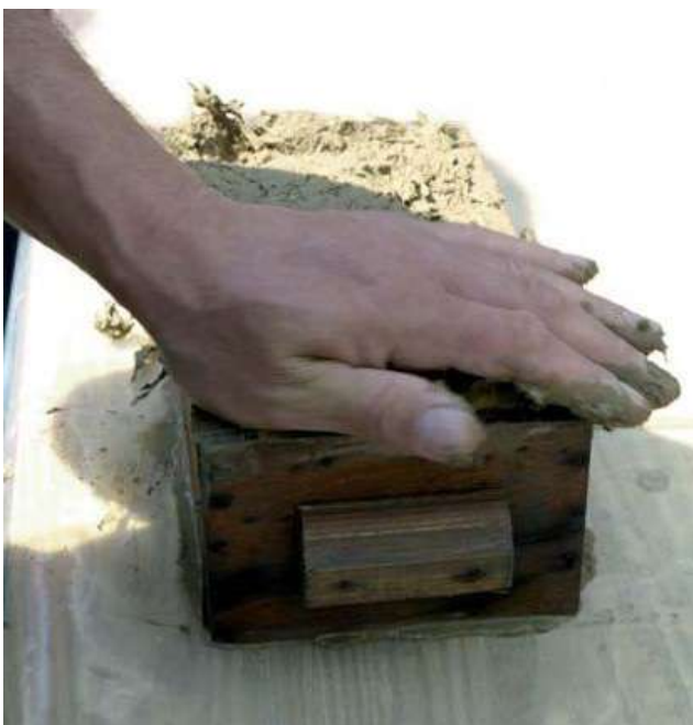
7.) STAVLJANJE SMJESE U KALUP
