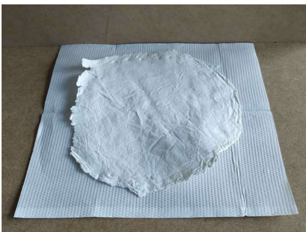
Uzorak papira sa dodanim lanenim uljem
