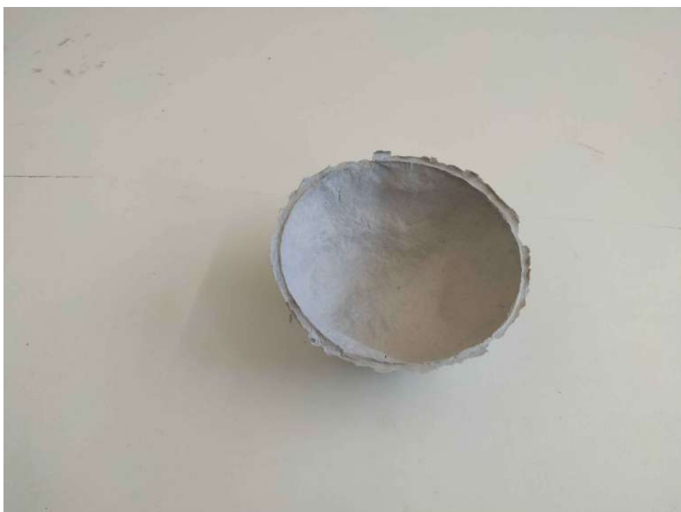
2 Unutrašnja strana uzorka dobivenog korišenjem cjedila kao kalupa
