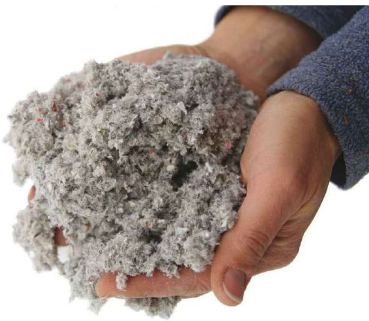
Vlakna celuloze dobivena mljevenjem novinskog papira
