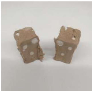
5.4 - natronski papir i EPS kuglice u kalupu
