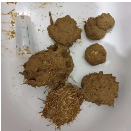
6.) UZORCI RAZLIČITOG OMJERA PILJEVINE
