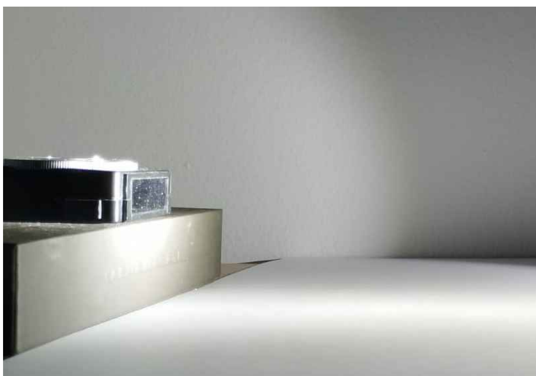
Postav za mjerenje jaskosti osvjetljenja
