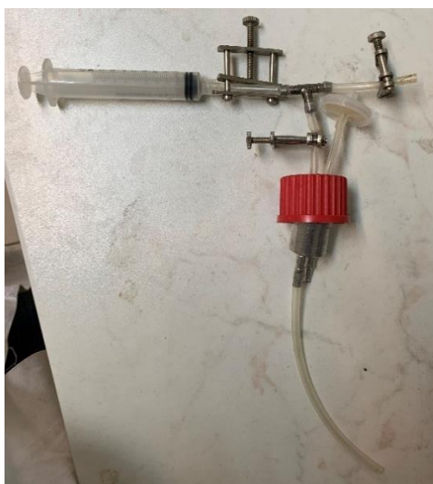
Slika 7. Aparatura za sterilno uzimanje uzorka reakcijske smjese iz reaktora
