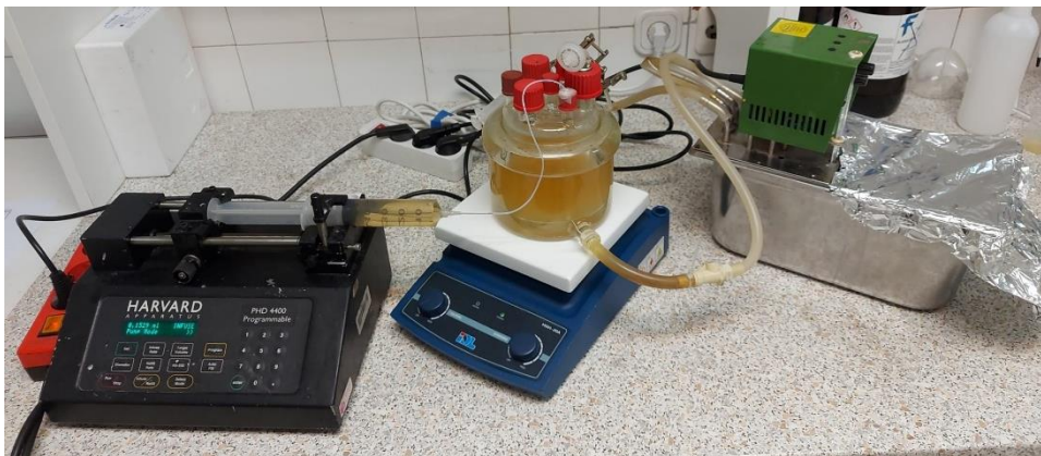
Slika 6. Aparatura za provedbu reakcije fermentacije u šaržnom reaktoru s dotokom supstrata
