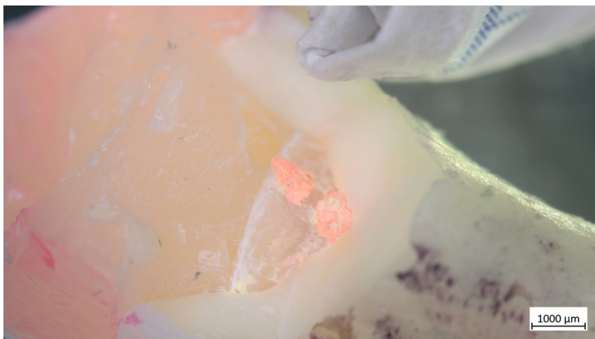
Slika 16. Uzorak EX skupine; nepovoljna fraktura (snimljeno stereo mikroskopom ZEISS Stemi 508 na povećanju 0,63x)
