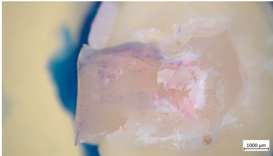
Slika 14. Uzorak SIC skupine; povoljna fraktura (snimljeno stereo mikroskopom ZEISS Stemi 508 na povećanju 0,63x)
