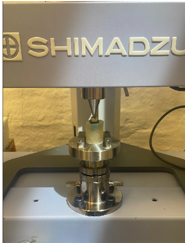
Slika 5. Ispitivanje zuba na univerzalnoj kidalici.
