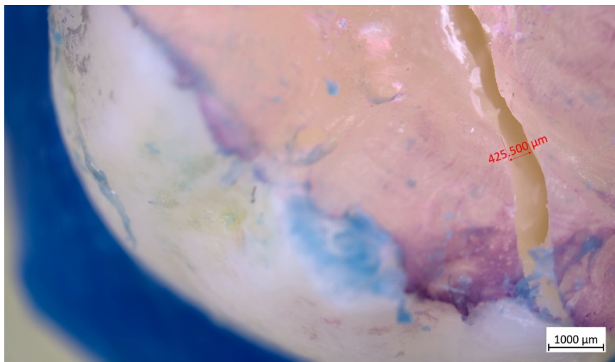
Slika 15. Uzorak BF skupine; povoljna fraktura (snimljeno stereo mikroskopom ZEISS Stemi 508 na povećanju 0,63x)
