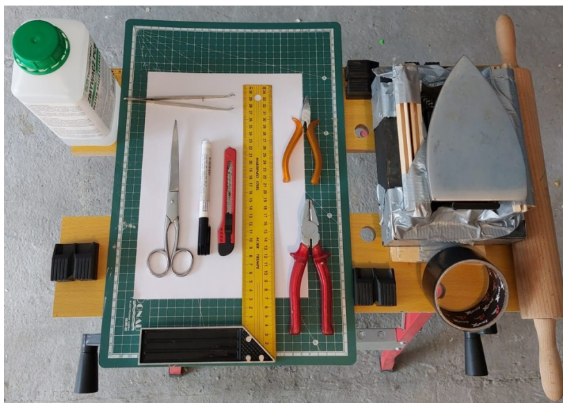
Slika 2.6. Oprema za korak prijenosa tonera toplinom (termo transfer).
