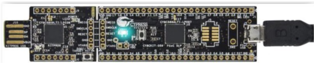
Slika 3.1. Razvojni sustav PSoC 5LP 059 korišten za napajanje i akviziciju izmjerenih signala, [10].
