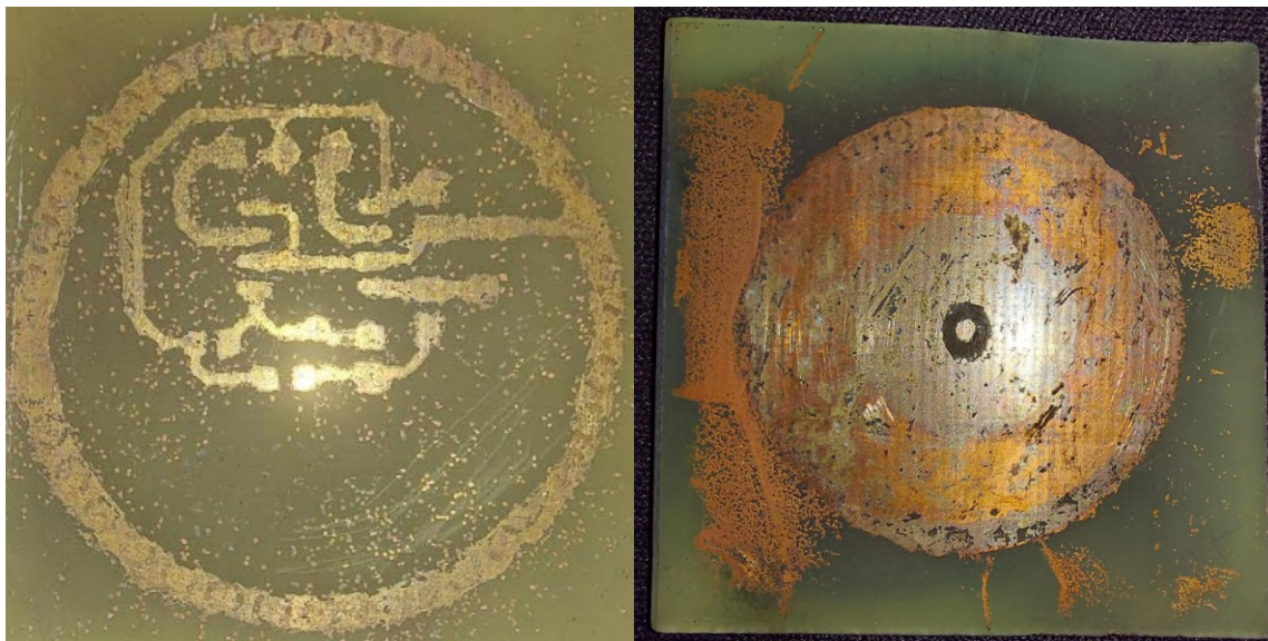
Slika 2.23. Točkasti ostatci neizjetkanog bakra uslijed nanosa peludi.
