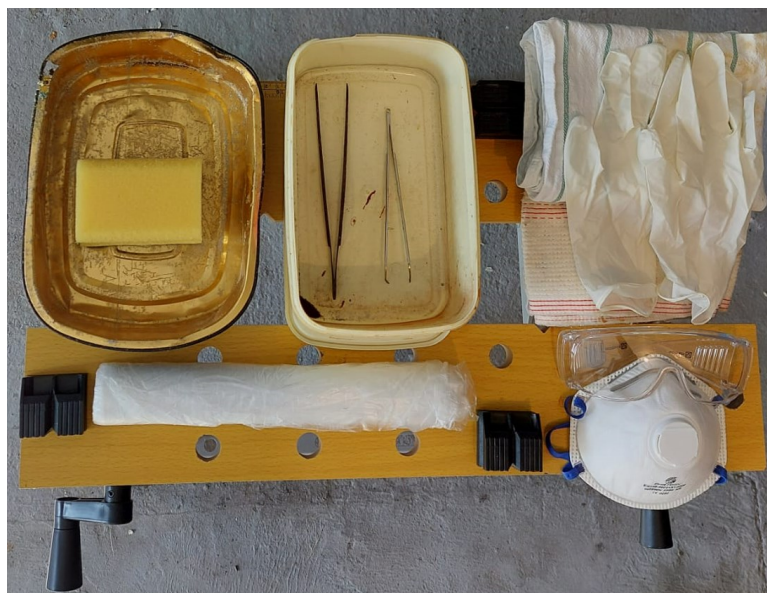
Slika 2.8. Oprema za postupak jetkanja.
