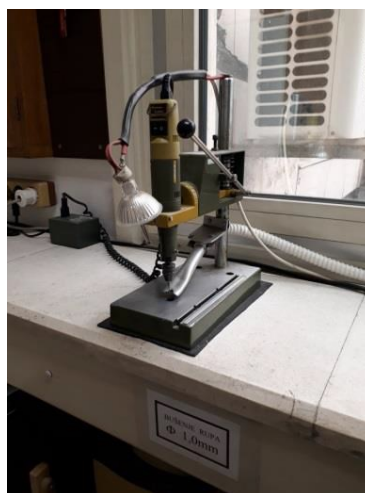
Slika 2.18. Korištena laboratorijska bušilica na stalku, [1].
