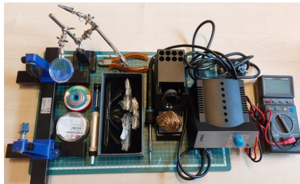
Slika 2.14. Oprema za ugradnju i lemljenje komponenata te optičku i vizualnu inspekciju ispravnosti spojeva.
