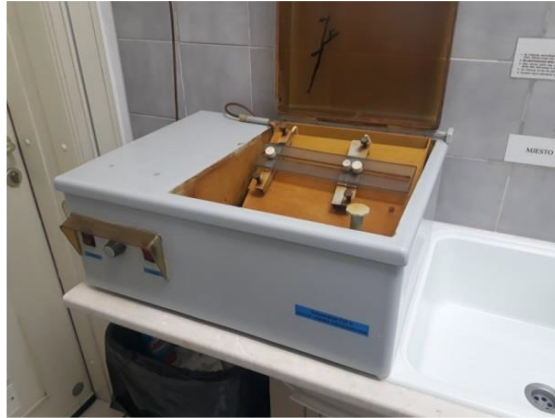
Slika 2.17. Korišteni laboratorijski uređaj za jetkanje ferikloridom s pjenilicom, [1].
