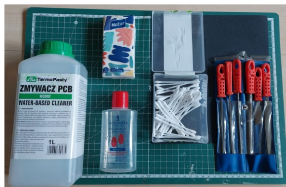
Slika 2.11. Oprema za čišćenje i finu obradu površina i rubova pločice.
