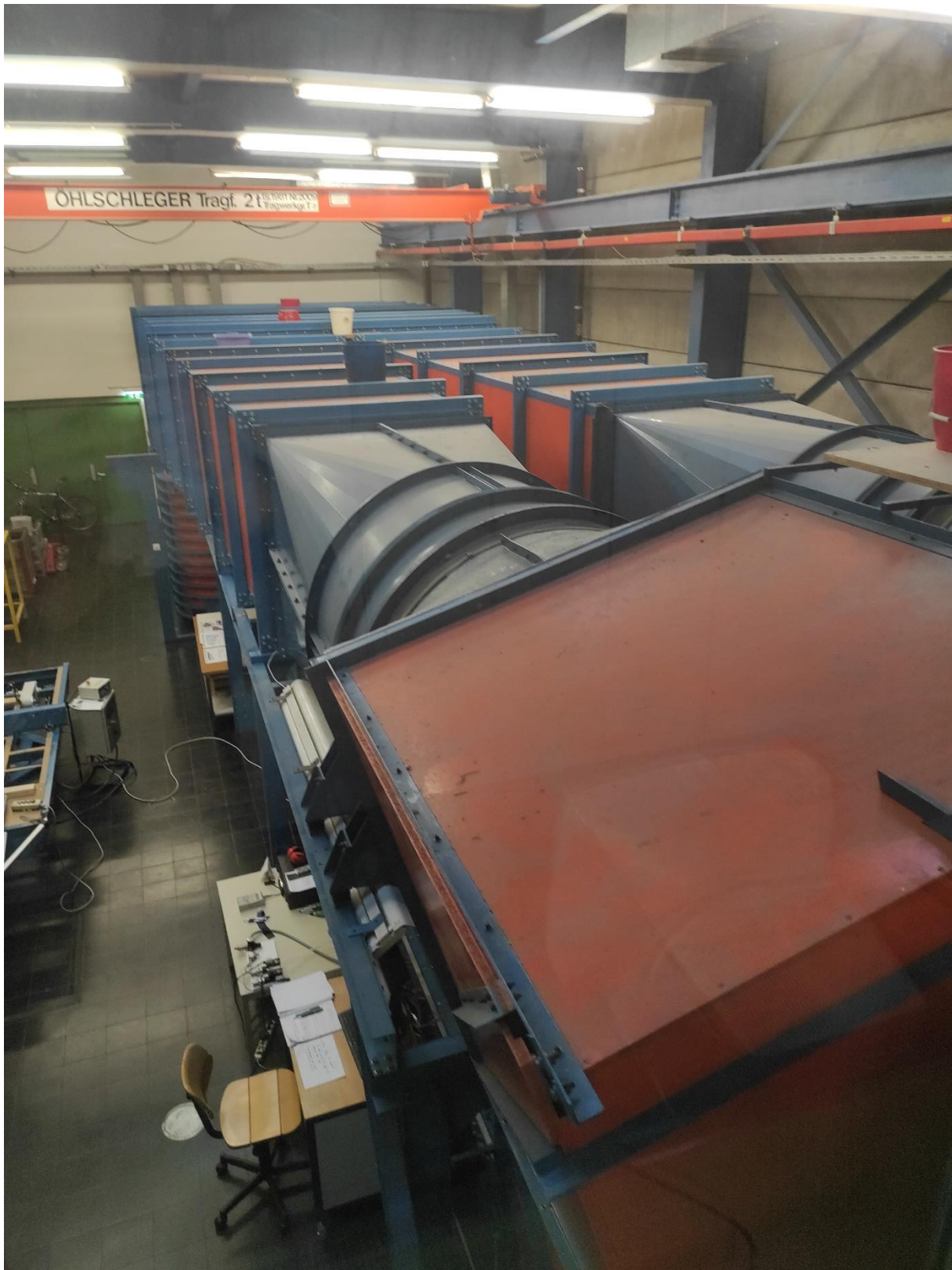
Slika 3.4: Fotografija zračnog tunela za generiranje AGS-a, pogled odozgo
