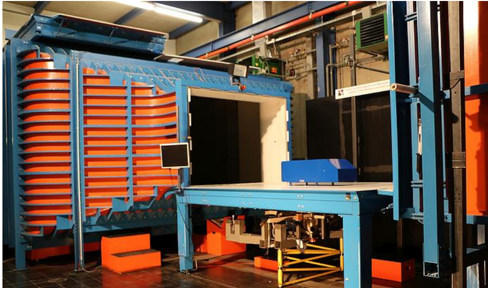
Slika 3.1: Fotografija ispitne sekcije podzvučnog aerodinamičkog zračnog tunela, prema [21]
