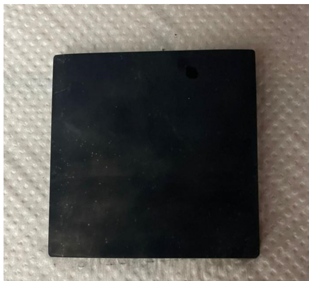
Slika 9. Patinirana Cu-Sn12 pločica
