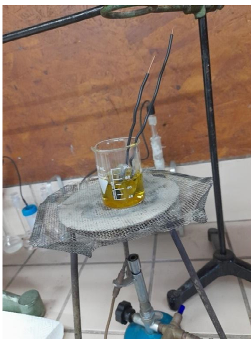
Slika 7. Prikaz procesa patinacije uranjem elektroda u pripremljenu vodenu otopinu
