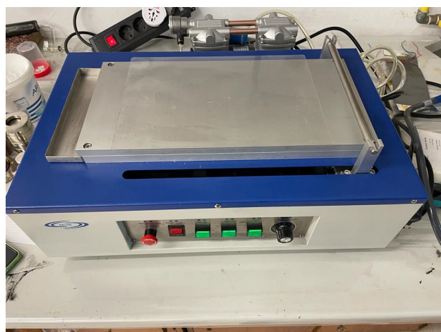
Slika 11. Aplikator kojim je nanesen premaz na patinirane Cu-Sn12 pločice ( lijevo ) i uređaj za premazivanje tvrtke Gelon( desno )
