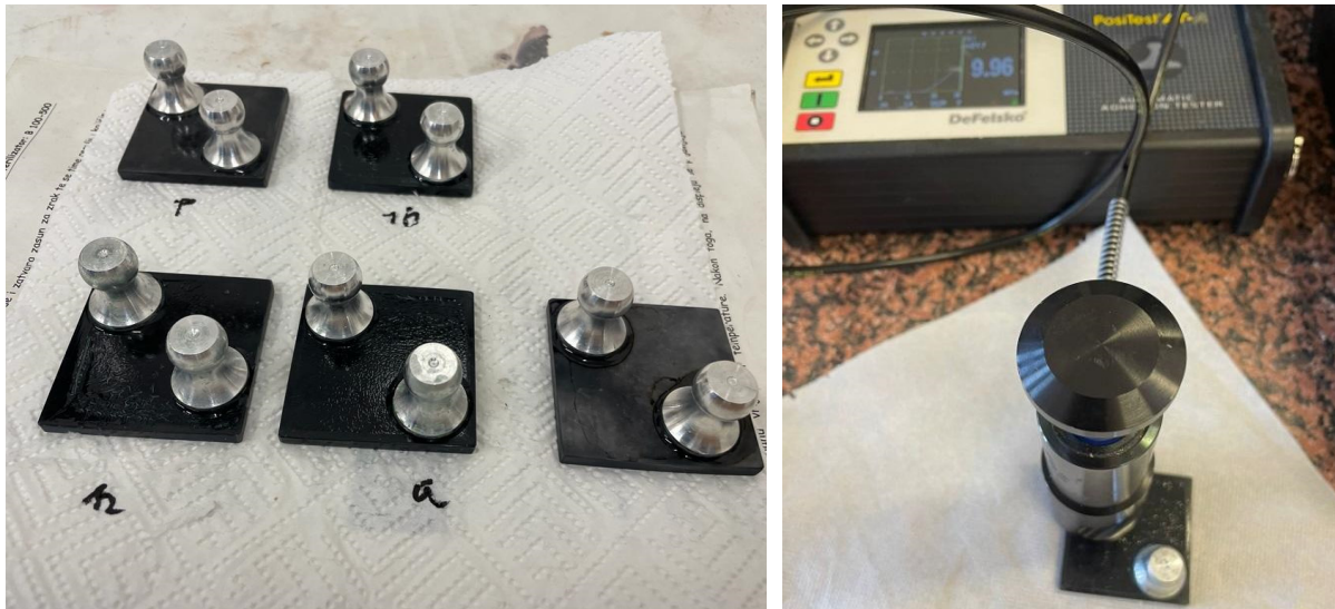
Slika 14. Prikaz čunjića nalijepljenih na Cu-Sn12 pločice ( lijevo ) i provedba pull-off testa pomoću uređaja PosiTest® AT ( desno )
