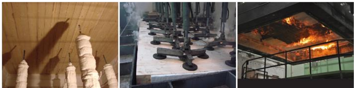
a) CLT neposredno prije testa b) Neizložena strana tijekom testa c) Izložena strana nakon testa
