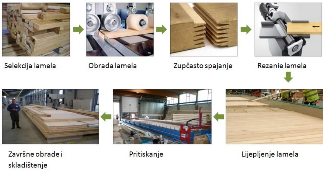
Slika 8.5 Postupak proizvodnje CLT panela
