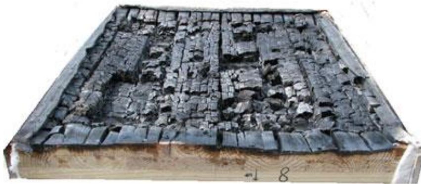
Slika 8.10 CLT ploča nakon ispitivanja
