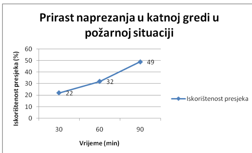
Slika 12.2 Prirast naprezanja u katnoj gredi
