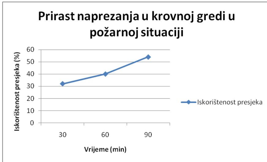
Slika 12.3 Prirast naprezanja u krovnoj gredi
