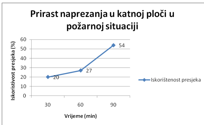
Slika 12.4 Prirast naprezanja u katnoj ploči
