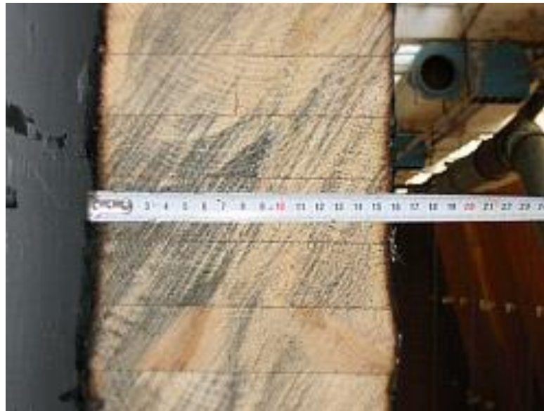
Slika 7.3 Drveni nosač izložen požarnim temperaturama za vrijeme od 1 sata izgubio je 4 cm po svom opsegu[16]
