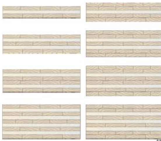
Slika 8.2 Mogući poprečni presjeci CLT panela
