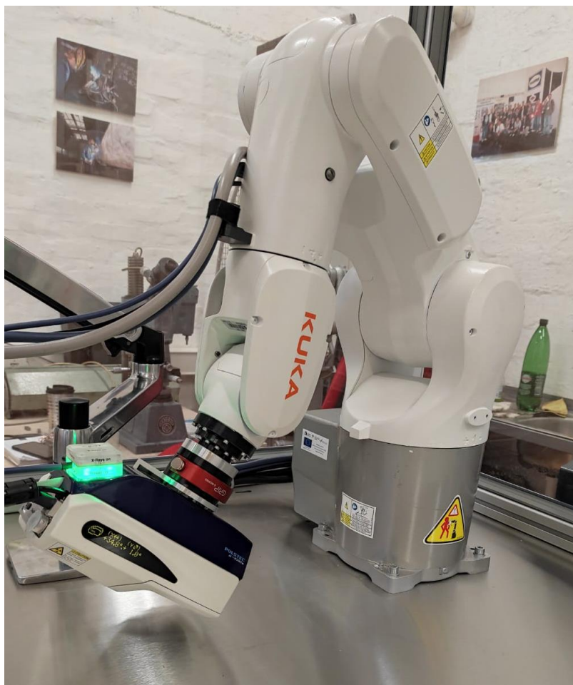
Slika 32. \mu -X360s prijenosni rendgenski analizator s robotskim manipulatorom
