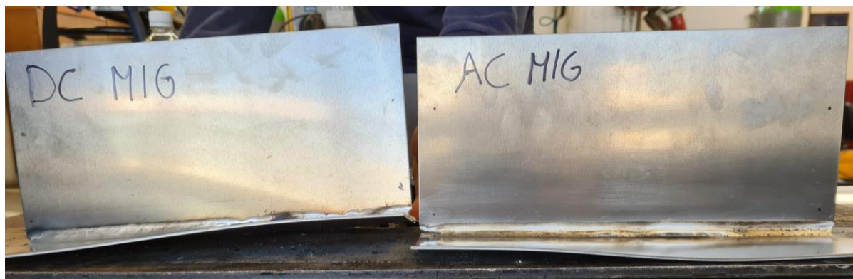
Slika 44. Usporedni prikaz deformacija MIG-P/AC MIG
