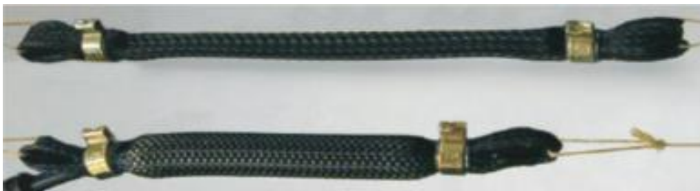
Slika 67. McKibbenov pneumatski mišić
