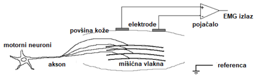
Slika 50. Princip rada EMG senzora
