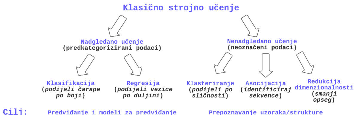
Slika 6: Usporedba tehnika klasičnog strojnog učenja, prema [38]
