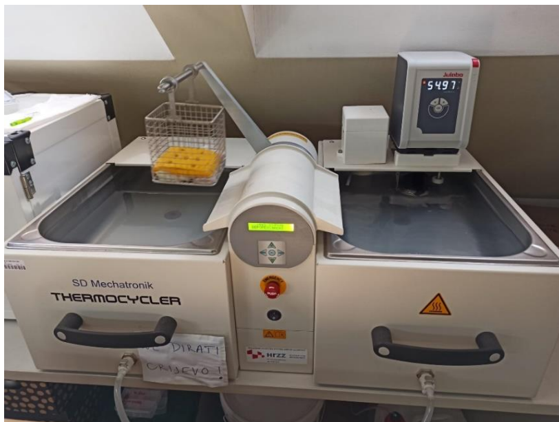
Slika 9. Termocikliranje kompozitnih uzoraka između 5 i 55 °C
