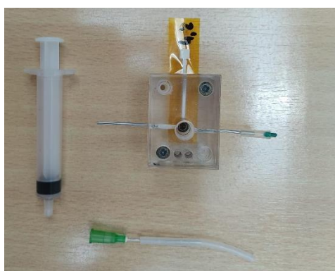
Slika 15. Protočna ćelija za kondicioniranje i baždarenje ispisanih elektroda
