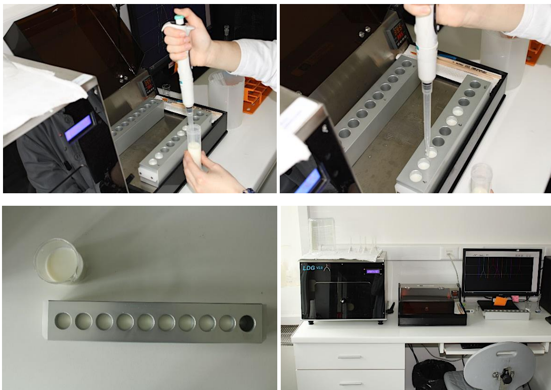
Slika 4 Postupak određivanja koagulacijskih svojstava mlijeka na formagrafu (vlastiti izvor)
