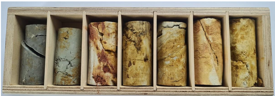
Slika 4.2. Različiti uzorci glina s područja klizišta Bedekovčina
