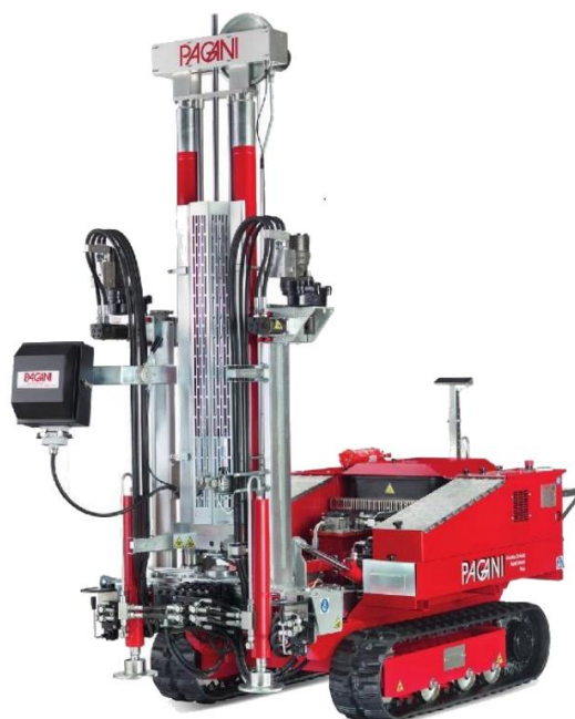
Slika 5.5. Hidraulički penetrometar za utiskivanje, Pagani TG 63 -150
