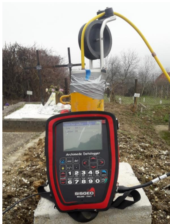
Slika 5.10. Ugrađeni inklinometar 1 na području starog groblja u Bedekovčini
