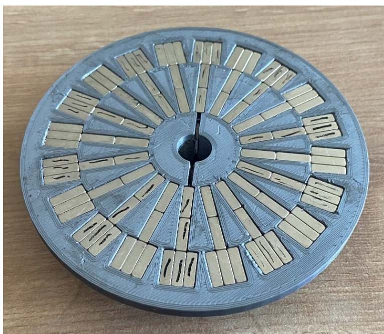
Slika 3.19: Rotor sa segmentiranim polovima
