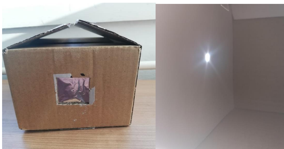
Slika 6. Lijevo: kutija za promatranje Sunčevih pjege, desno: slika Sunca na bijelom papiru unutar kutije
