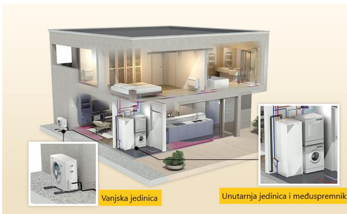
Slika 11. Shematski prikaz sustava zrak-voda dizalice topline [20]
