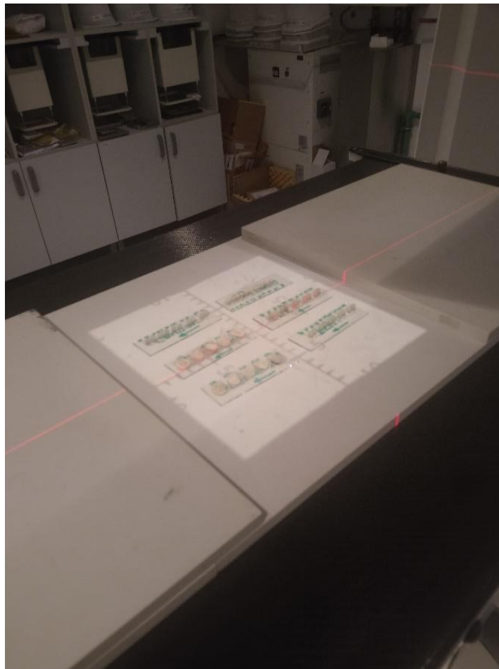
Slika 10. Postavljanje snopa za ozračivanje uzorka
