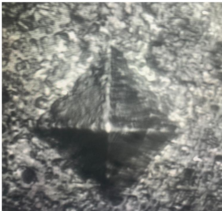
Slika 6. Otisak piramide na površini materijala
