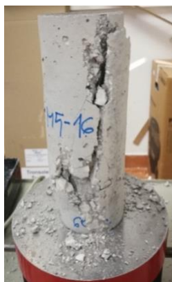
Slika 20 Izgled loma uzorka nakon ispitivanja tlačne čvrstoće
