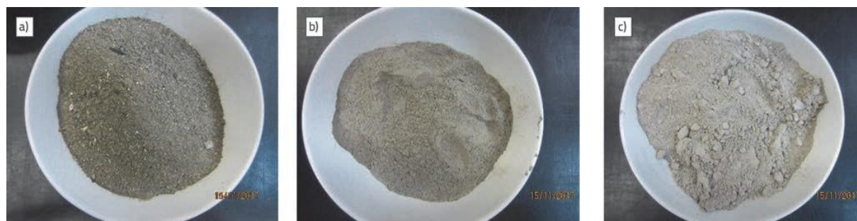
Slika 3 Uzorci PDB-a: a) pepeo s dna peći, b) leteći pepeo krupnije frakcije, c) finiji leteći pepeo [7]
