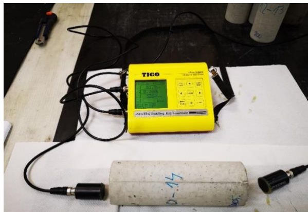
Slika 26 Ispitivanje brzine prolaska ultrazvuka kroz uzorak
