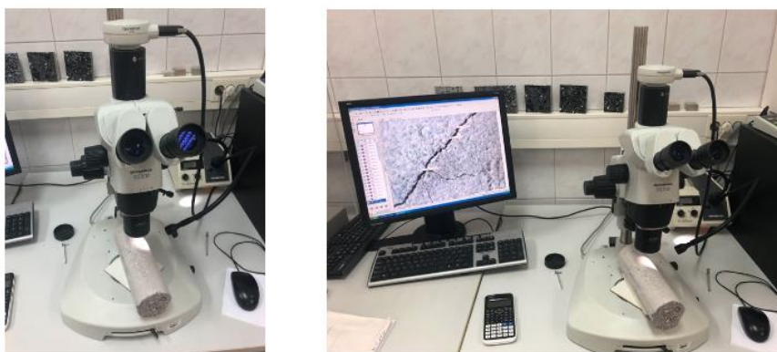
Slika 27 Optički mikroskop (lijevo), mjerenje pukotina pomoću računalnog programa (desno)
