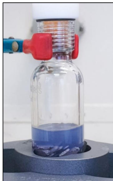
Slika 12. Wurtzova reakcija dobivanja 1,1'-biadamantana ( 1 ) u n -heptanu u visokotlačnoj aparaturi.
