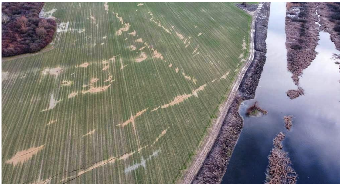
Slika 3. Manifestacija likvefakcije u polju u Topolovcu: a) izbijanje pijeska na površinu b) vidljive površinske pukotine u polju kraj rijeke
