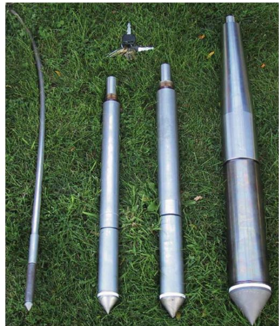
Slika 6. CPT sonda: a) shematski prikaz CPT sonde; b) veličine CPT sonde (s lijeva: 2 cm 2 , 10 cm 2 , 15 cm 2 i 40 cm 2 )
