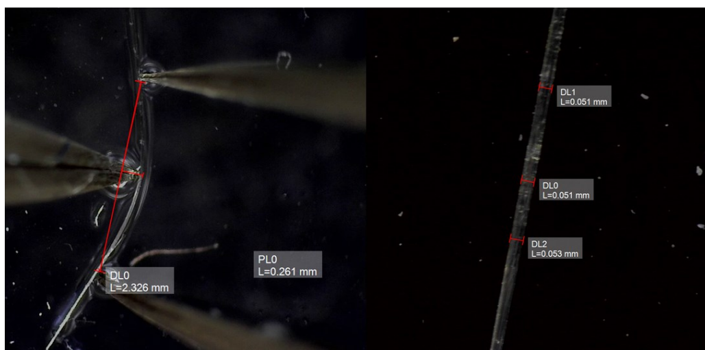
Slika D46. Eksperiment savijanja kristala spoja 8 (uzorak 3). Lijevo su prikazane izmjerene vrijednosti za maksimalni pomak i duljinu kristala, a desno vrijednosti debljine kristala.
