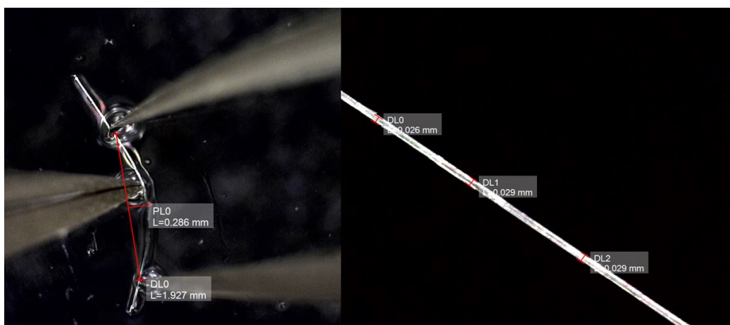
Slika D42. Eksperiment savijanja kristala spoja 6 (uzorak 5). Lijevo su prikazane vrijesnosti maksimalnog pomaka i duljine kristala, a desno debljina kristala.
