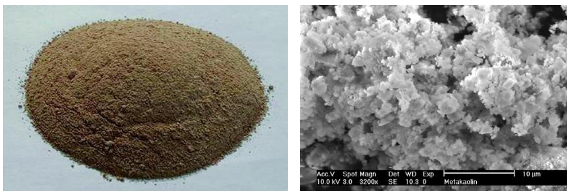
Slika 7 a) Metakaolin [2] b) Morfologija metakaolina- SEM električnim mikroskopom [7]
