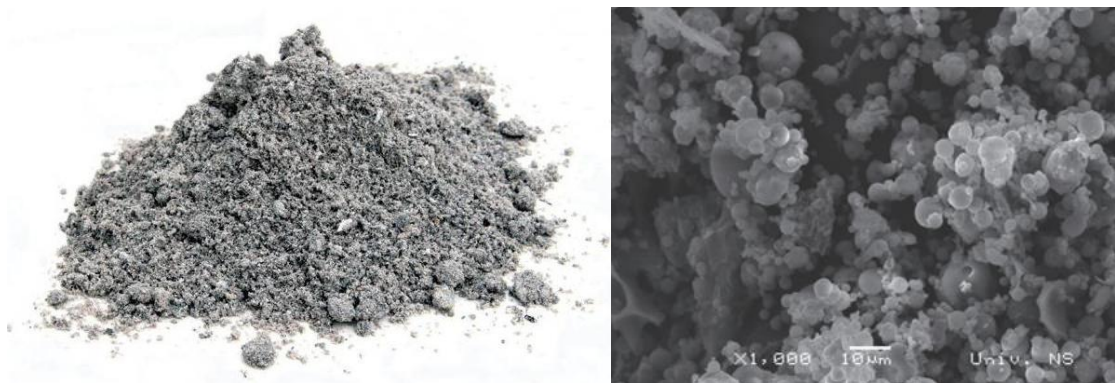
Slika 9 a) Leteći pepeo [12], b) SEM slike: čestice letećeg pepela uvećane 1000 puta [13]
