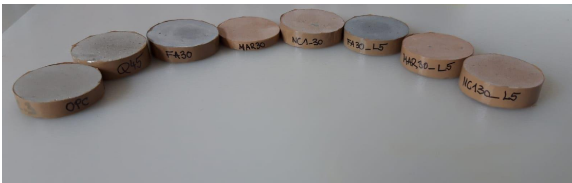
Slika 19 Uzorci cementnih mješavina nakon vakumiranja
