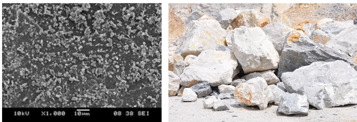
Slika 8 a) Čestice vapnenca snimljene skenirajućim elektronskim mikroskopom (SEM) [8], Vapnenac u sedimentnom obliku [9]
