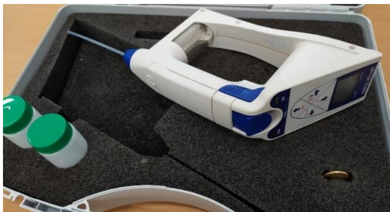
Slika 5. Densitometar Mettler Toledo Densito 30PX.
