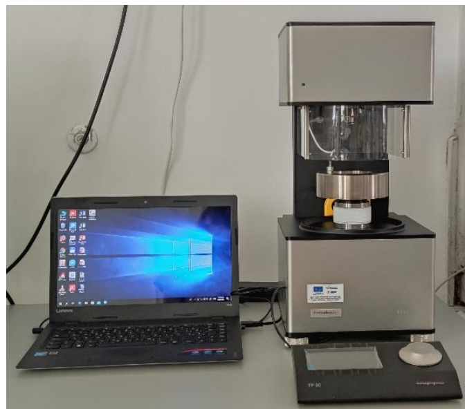
Slika 9. Tenziometar DCAT-8T, Dataphysic.
