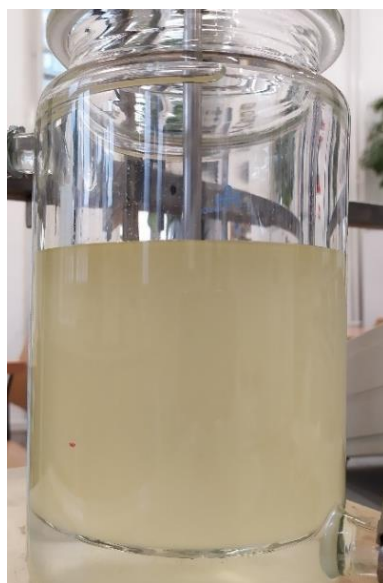
Slika 14. Stanje potpune disperzije pri brzini vrtnje miješala 1005 \text{ min}^{-1} u sustavu EG:SU=0,10:1 u posudi za miješanje promjera D_2 .
