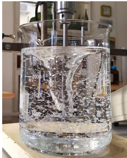
Slika 10. Pojava vrtloga kod miješanja etilen-glikola pri brzini vrtnje miješala n = 1004 \text{ min}^{-1} u posudi za miješanje promjera D_3 .
