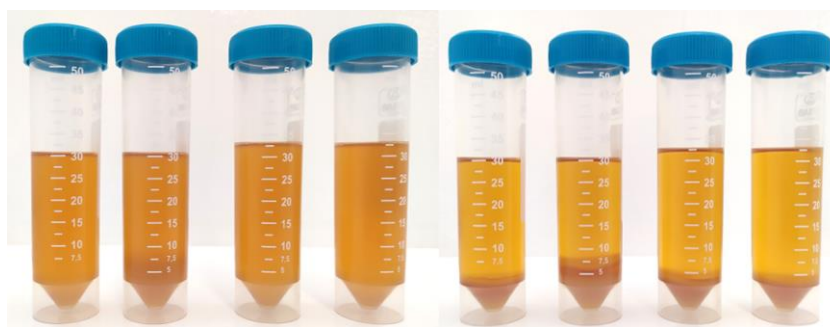
Slika 8. Uzorci iz sustava DES2:otpadno ulje = 0,10:1 prije (lijevo) i nakon centrifugiranja (desno).
