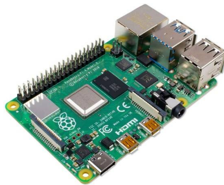
Slika 2.5. Raspberry Pi 4 B mikroročunalo
