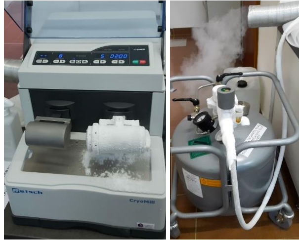
Slika 20. Kriomlin s tekućim dušikom kao radnim plinom korišten za usitnjavanje MP-a.
