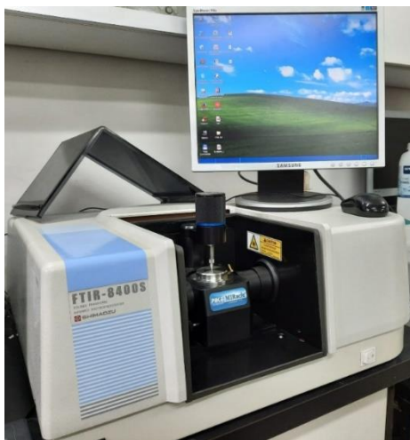
Slika 23. FTIR-ATR uređaj korišten za snimanje spektara PS-a i PVC-a.
