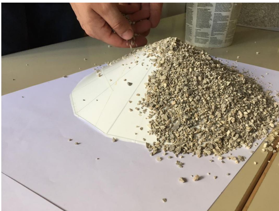
Slika 6-7 Izrada referentne hrpe (Kostrić, 2018)
