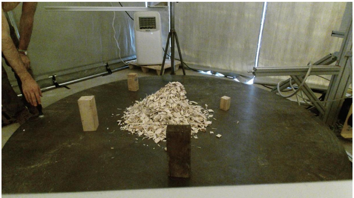
Slika 5-4 Stožasta hrpa materijala sačinjena od drvene piljevine (Rackl i Grötsch, 2018)
