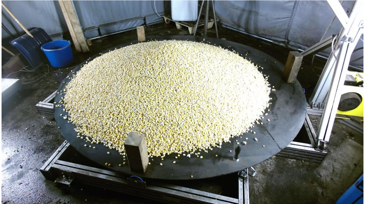
Slika 5-3 Stožasta hrpa materijala sačinjena od suhих kukuruznih zrna (Rackl i Grötsch, 2018)
