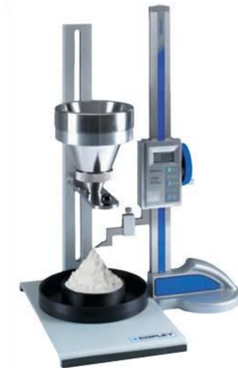
Slika 2-4 Mjerenje visine hrpe materijala digitalnim uređajem (Mistry i dr., 2017)
