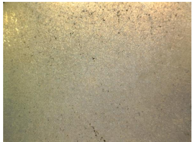
Slika 38. Slike dobivene optičkim mikroskopom za uzorak RG7 bronce tretiran s 0,01 M H 2 O 2 pri temperaturi od 40°C uz povećanje od 50x prije i nakon tri tjedna izlaganja kiseloj kiši
