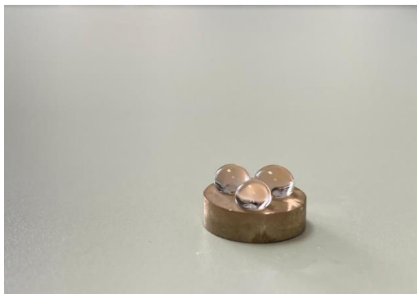
Slika 33. Kontaktni kut uzorka RG7 bronce tretiranog s 0,01 M HDPA pri 40°C prije i nakon tri tjedna izlaganja kiseloj kiši
