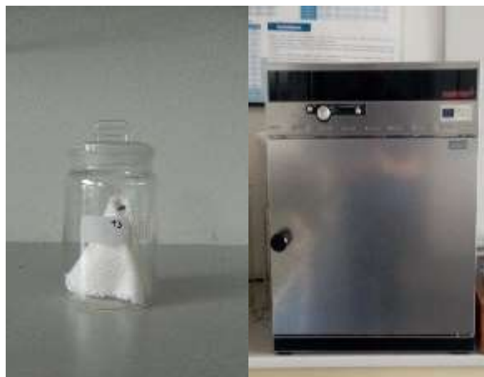
Slika 27. Ispitivanje apsorpcije vlage pletiva čarape: a) uzorak pletiva, b) sušnica
