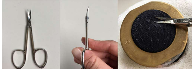
Slika 31. Rezanje grudica zamršenih vlakana na površini ispitivanog pletiva čarape [8]
