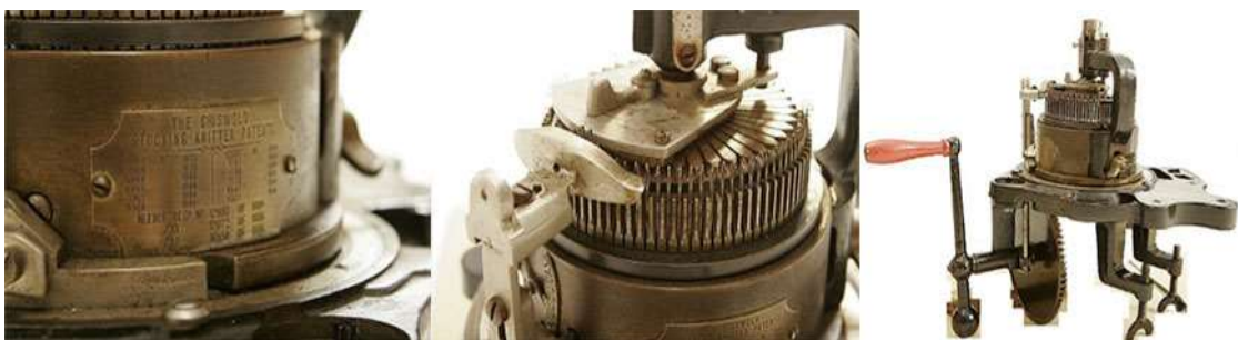
Slika 3. Stroj za pletenje čarapa iz 1872. godine, izumitelja Griswold-a
