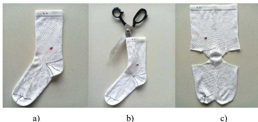
Slika 24. Priprema uzorka čarape za ispitivanje: a) cijela čarapa, b) razrezivanje čarape, c) čarapa pripremljena za uzorkovanje pletiva
