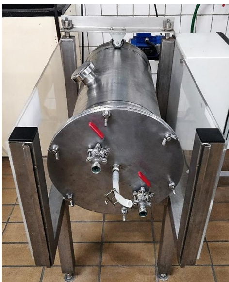
Slika 13. Horizontalni rotirajući cijevni reaktor (izvor: vlastita fotografija).
