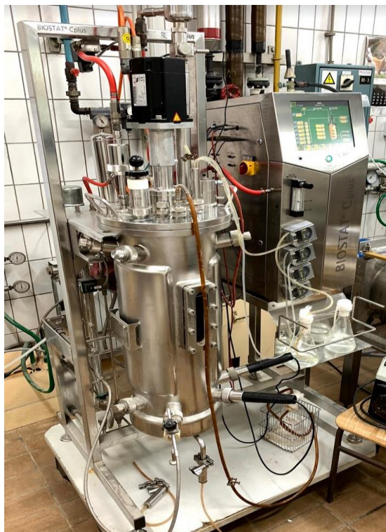
Slika 11. Bioreaktor s miješalom Biostat Cplus (izvor: vlastita fotografija).
