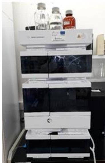
Slika 15. Uređaj za tekućinsku kromatografiju ultravisoke djelotvornosti (UPLC) (izvor: vlastita fotografija).
