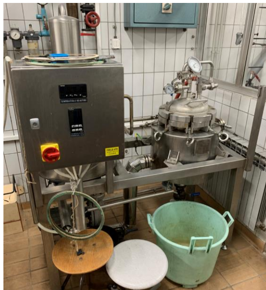
Slika 14. Visokotlačni reaktor za obradu lignoceluloznih sirovina (izvor: vlastita fotografija).
