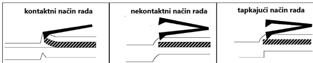
Slika 8. Načini rada AFM-a. Slika je preuzeta i dorađena iz reference 31.
