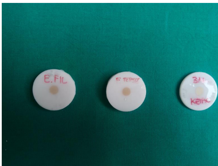
Slika 3. Kalupi za izradu uzoraka za određivanje tvrdoće materijala
