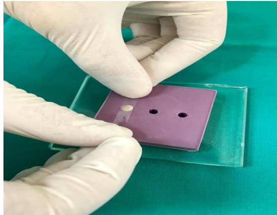
Slika 1. Priprema uzoraka za određivanje tlačne čvrstoće
