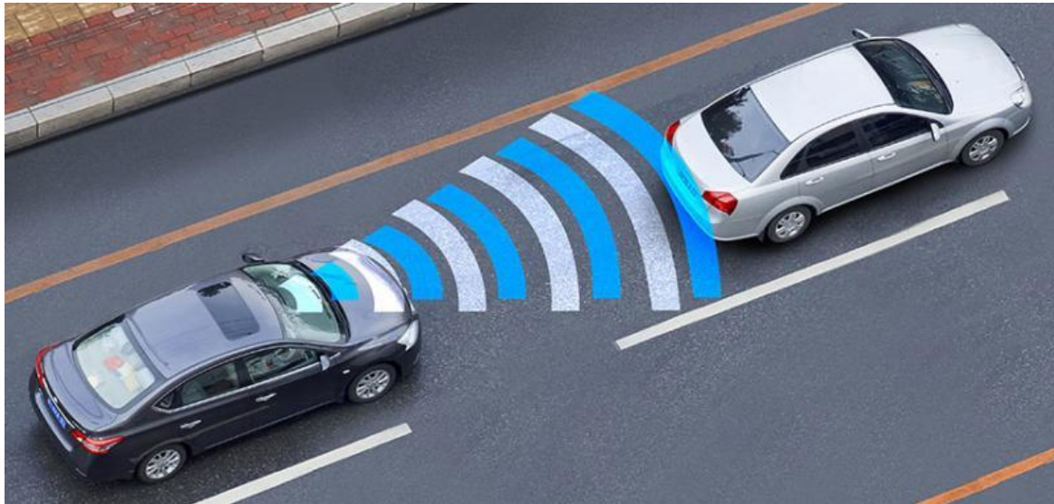
Slika 2. Sustav upozorenja na prednji sudar
