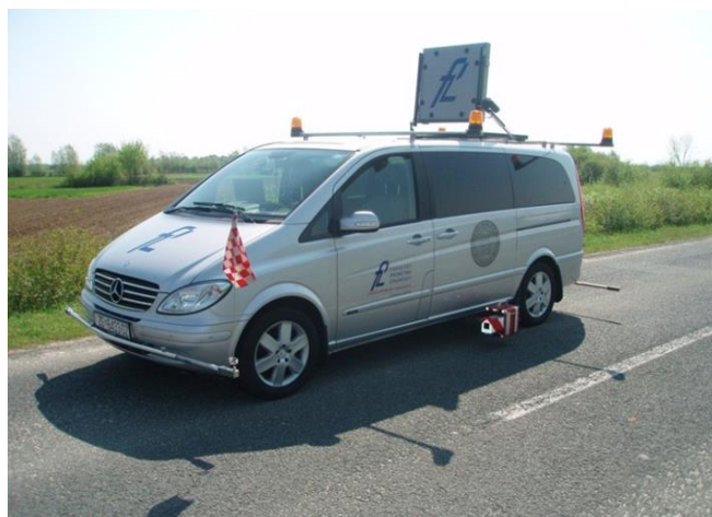
Slika 10. Mjerno vozilo s montiranim uređajem ZDR 6020
