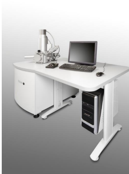
Slika 28. Pretražni elektronski mikroskop Tescan Vega III Easyprobe [46]
