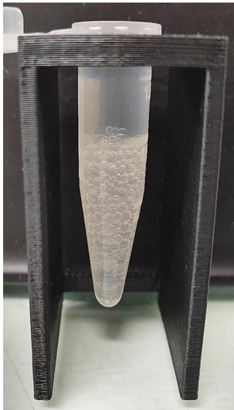
Slika 98. Prikaz nastale emulzije u epruveti pri velikim protocima ulja i vode – disperzija je stabilna
