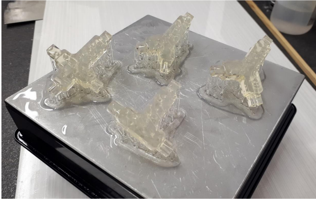
Slika 42. Prikaz 3D-ispisanih generatora kapljica s potpornom strukturom na metalnoj podlozi
