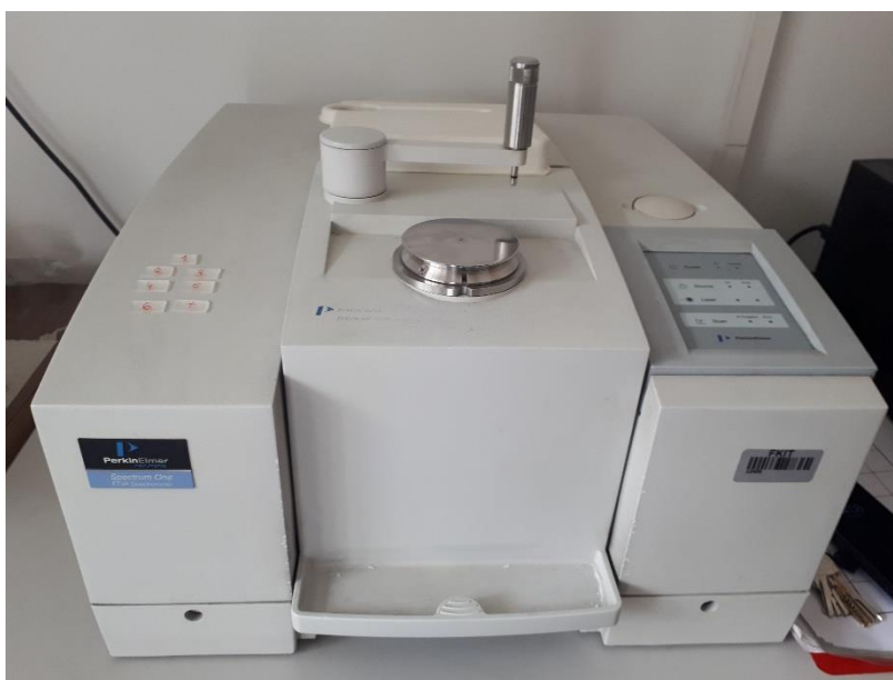
Slika 25. FTIR spektrometar Perkin Elmer, Spectrum One
