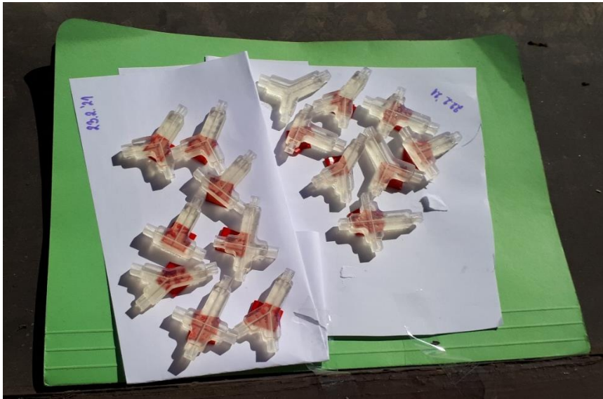
Slika 44. Prikaz očvršćivanja smole na površinama generatora kapljica pomoću sunčevog zračenja
