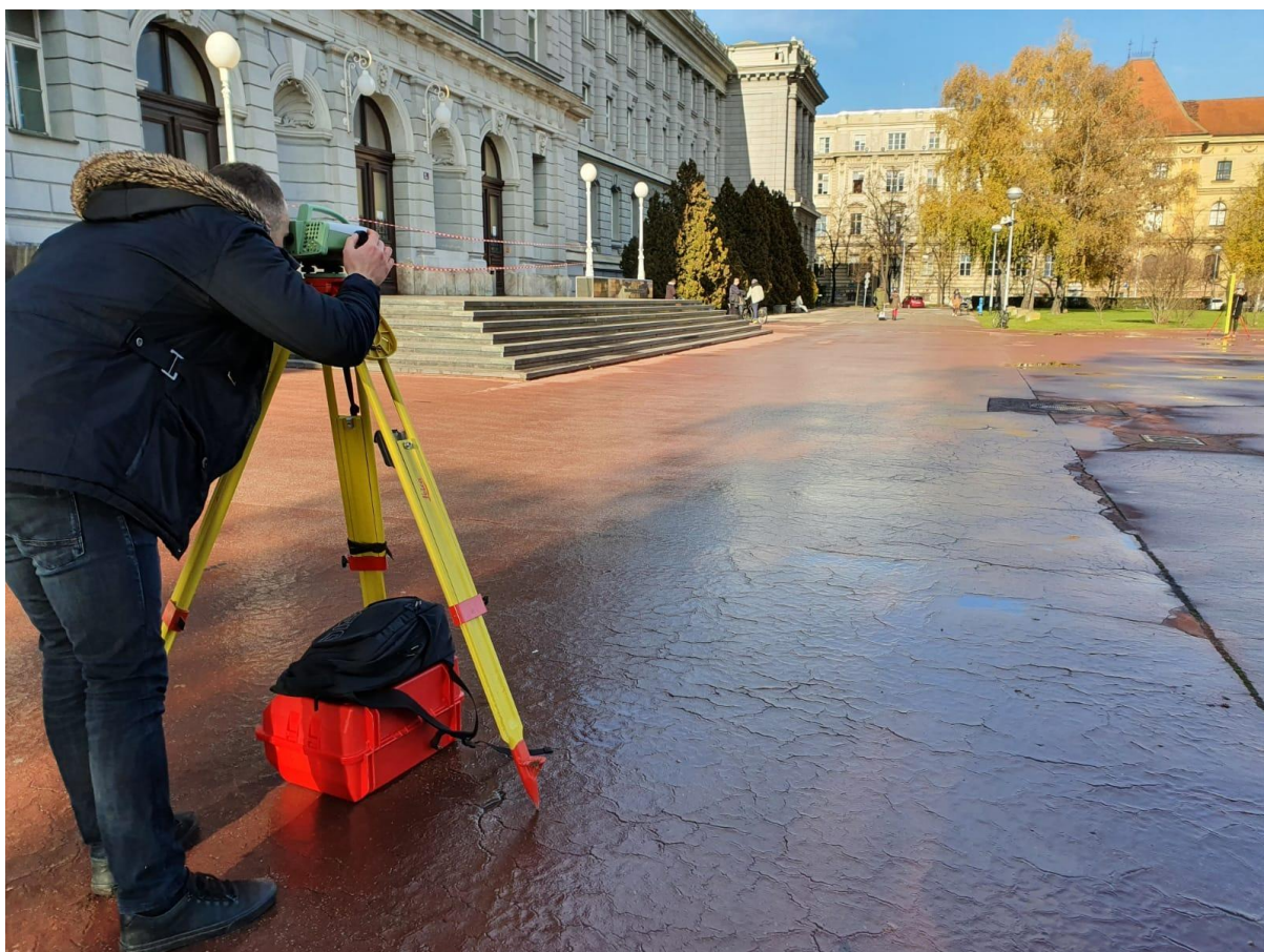
Slika 6. Niveliranje u smjeru naprijed.
