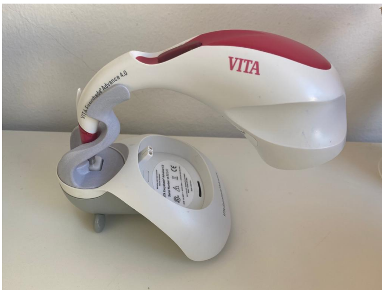
Slika 6. Spektrofotometar Easyshade Advance 4.0 (VITA Zahnfabrik, Bad Sackingen, Germany)
