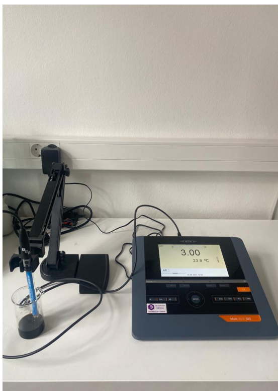
Slika 14. Mjerenje pH Acteta balsamica
