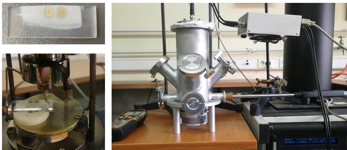
Slika 2: Uzorak CeO 2 u obliku tankog filma na FTO stakalcu sa zlatnim elektrodama (priprema površine za mjerenje, lijevo gore), uzorak spojen na ćeliju instrumenta (lijevo dolje) i aparatura za mjerenje relativne vlažnosti (desno).
