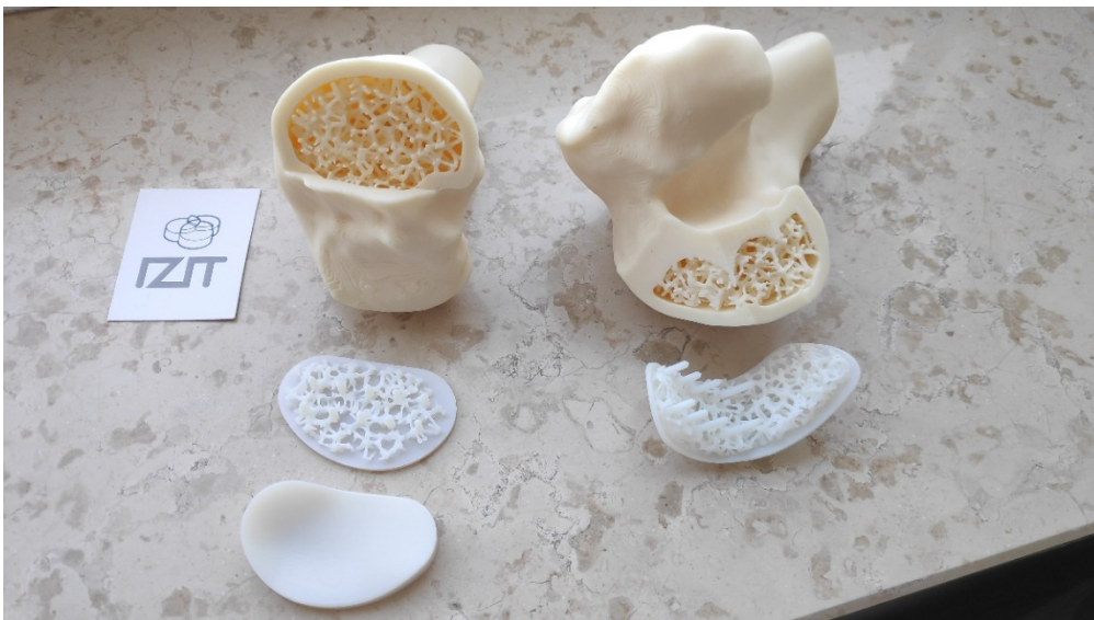
Slika 22. Isprintana oba dijela koljena te rastavljena PEP.
