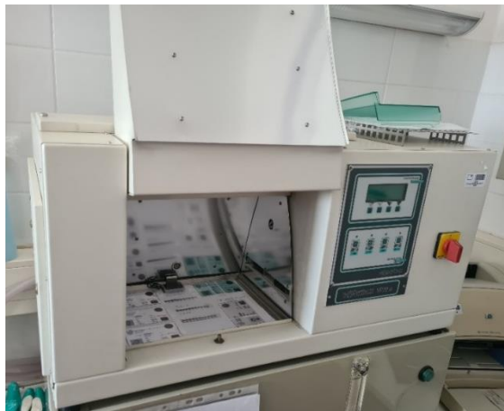
Slika 12: Solarbox 1500e, uređaj za starenje uzoraka
