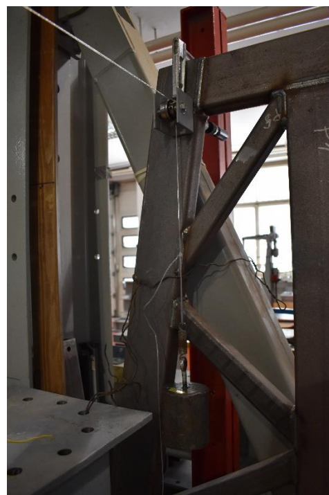
Slika 42. a) statičko opterećenje i b) uteg obješen preko koloture
