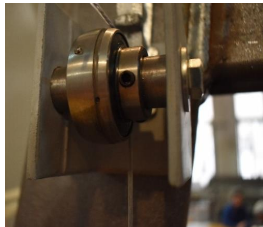
Slika 43. Detalj a) doza na vrhu stupa i b) kuglični ležaj (kolotura)
