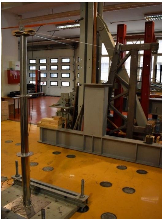
Slika 42. a) statičko opterećenje i b) uteg obješen preko koloture
