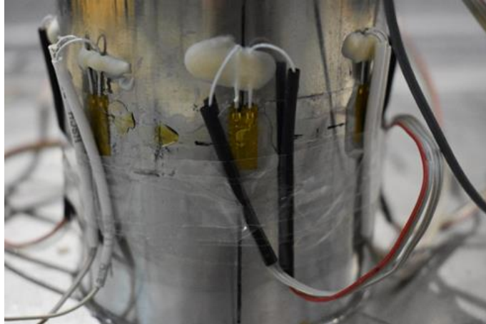
Slika 35. Elektrootporni tenzometri postavljeni na podnožju modela
