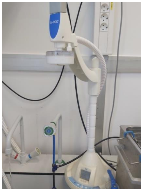
Slika 15. uređaju za pripremu MilliQ ultračiste vode Advantage A10 (Millipore Sigma, Burlington, Massachusetts, SAD)
