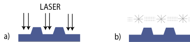
Slika 16: Postupak izrade tiskovne forme laserskim graviranjem; a) graviranje i b) ispiranje tiskovne forme
