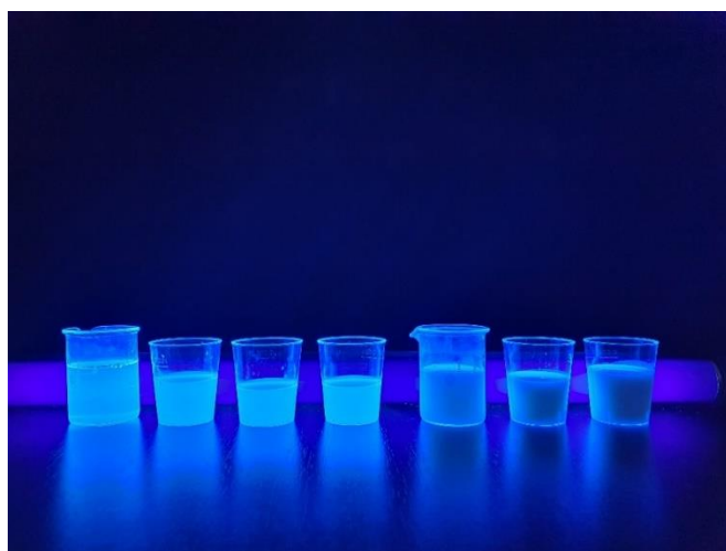
Slika 26: Tiskarska boja s dodatkom nanočestica (s lijeva na desno: UV_FB, UV_FB + 0,5% SiO 2 , UV_FB + 1% SiO 2 , UV_FB + 1,5% SiO 2 , UV_FB + 0,5% TiO 2 , UV_FB + 1% TiO 2 , UV_FB + 1,5% TiO 2 )
