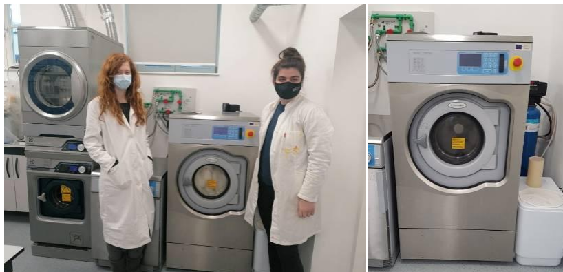
Slika 44. Prikaz postupka ispitivanja postojanosti obojenja na pranje u industrijskoj perilici rublja
