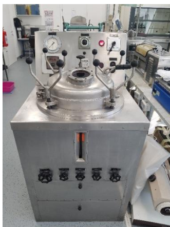
Slika 28. Autoklav za bojadisanje i oplemenjivanje Scholl u Zavodu za tekstilnu kemiju i ekologiju Sveučilišta u Zagrebu Tekstilno-tehnološkog fakulteta
