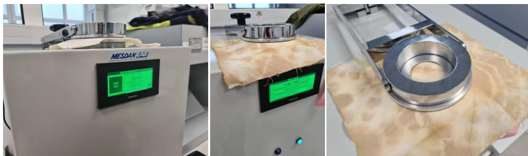
Slika 41. Pravilno postavljanje uzorka na mjerno mjesto i mjerenje propusnosti zraka
