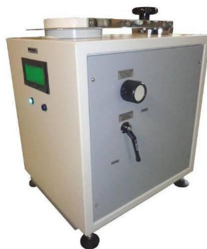
Slika 39. Aparat za ispitivanje propusnosti zraka Branca Idealair Air Permeability Tester 37S
