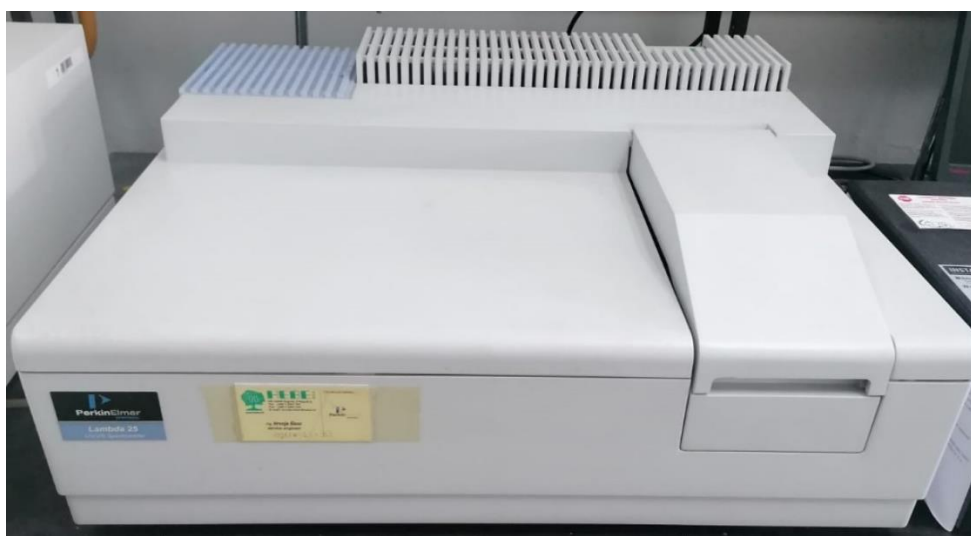
Slika 16. UV/VIS spektrofotometar (Lambda 25, PerkinElmer, Waltham, SAD) korišten za određivanje ukupnih proteina i emulgirajućih svojstava (Vlastita fotografija)
