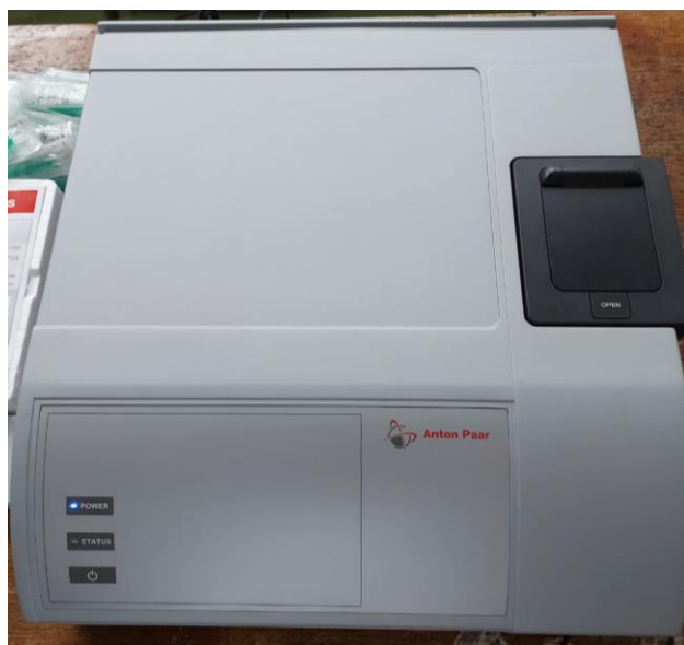
Slika 17. Uređaj za analizu čestica Litesizer 500 (Anton Paar GmbH, Graz, Austrija) (Vlastita fotografija)
