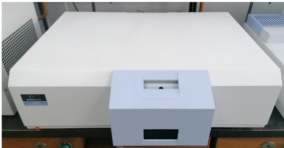
Slika 18. Fluorimetar (LS 55, PerkinElmer, Waltham, SAD) korišten za analizu hidrofobnosti površine proteina (Vlastita fotografija)
