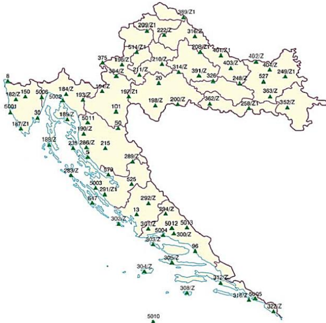
Slika 6. Raspored 78 stalnih točaka geodetske osnove (Premužić i Slevka 2008).
