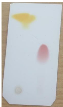
Slika 29. Primjer pločice presvučene silikagelom nakon provedene tankoslojne kromatografije
